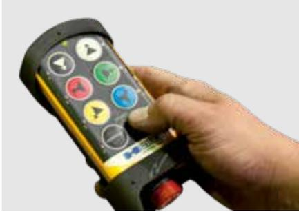
Manuelle und programmierbare Werkstück-Positionierungen über Fernbedienung
