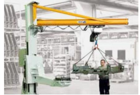
Mühesloses Be- und Entladen der Werkstücke mittels schwenkbarem Kranausleger
